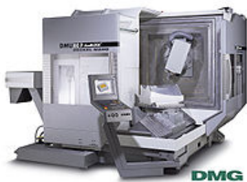
Fresadora CNC de cinco ejes con cabezal y mesa giratoria.
